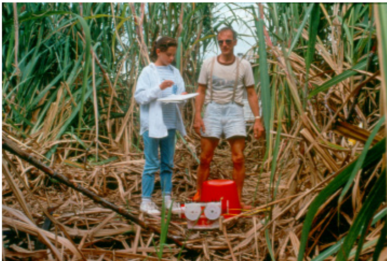
Figura 3-3. Kayla Sheets y Hartmut Spetzler conduciendo una inspección de resistividad en una plantación de caña de azúcar. El instrumento a sus pies documenta la resistencia del subsuelo al pasar la electricidad; los tubos a su izquierda son electrodos (no visibles en esta fotografía).
