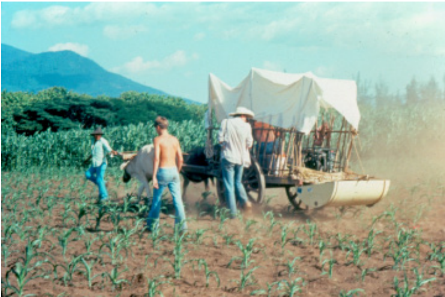
Figura 3-1. Radar de penetración terrestre recolecta información en la estratigrafía del subsuelo. La antena que recibe señal está ajustada en la parte posterior de la carreta. Dentro de la carreta se encuentra el osciloscopio, grabadora instrumental, grabadora gráfica, un generador eléctrico y el geofísico Hartmut Spetzler. Bill Loker camina a la par y Salvador Quintanilla guía a los bueyes Senate y Cubano, siguiendo la línea establecida.
